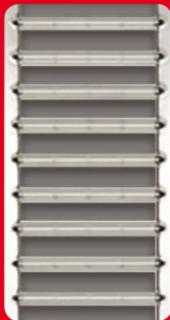
Grille Passerelle en acier inoxydable : Largeur 100 mm avec fente de 11,5 mm – Accès PMR – Marquage CE – NF EN 1433
