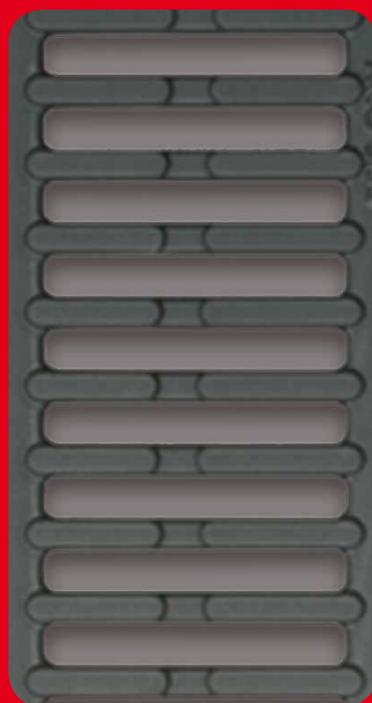
Grille Passerelle en fonte : Largeur 100 mm avec fente de 11 mm – Largeur 200 mm et 300 mm avec fente de 15 mm – Accès PMR – Marquage CE – NF EN 1433
